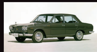
第二代Cedric首次搭載了日產首款SOHC引擎L20型。其最大輸出功率達到115ps，最大扭矩達到16.5kg-m。
