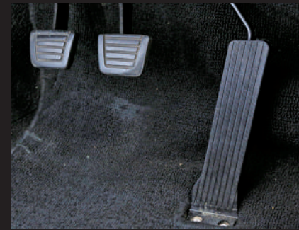
加速踏板採用了從地板下延伸的管風琴式設計。
