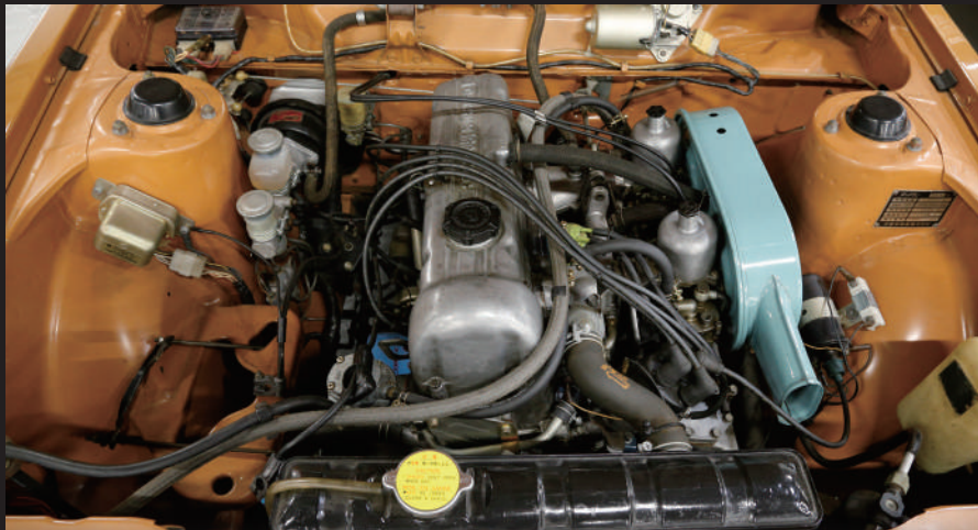
1600SSS Coupe的引擎室。配備了SU雙化油器的L16型引擎，發揮出100ps / 13.5kg-m的動力。
