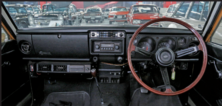
1600SSS Coupe的儀錶板周圍。除了在方向盤上安裝了大型發泡軟墊外，還進行了防眩處理，以增強安全性。
