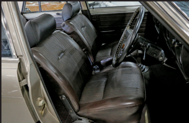
前座椅採用跑車式座椅，滑動距離比前代更長。頭枕也可選配。
